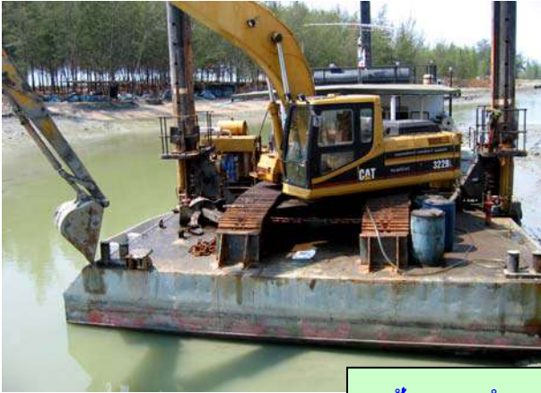
ปัญหาการนำรถขุดขึ้น-ลงจากโป๊ะ
